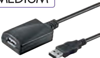
Aktives USB-Verlängerungskabel zum Anschluss von USB-Geräten nach dem USB-2.0-Standard. Maximal 3 dieser Kabel können für eine Gesamtlänge von 15 m aneinander gereiht werden. Das Kabel ist abwärtskompatibel zum USB-1.1- und USB-1.0-Standard.
