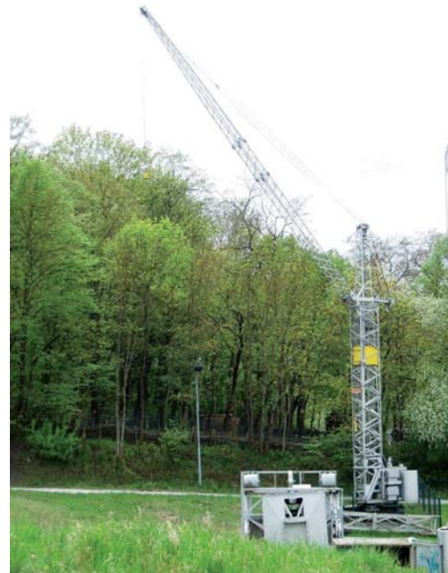
1955/56 gab der Baukran «Liebherr F 14 A» den neuen Massstab vor. Krane mit Teleskopturm und Spreizholmunterwagen sind im Kranbau – bis heute – noch weit verbreitet.
