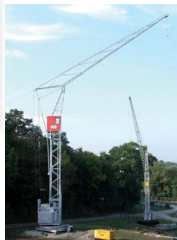
1950/51 und bis etwa 1960 baute das Schweizer Unternehmen Brun & Cie. den Turmdrehkran mit Biegebalkenausleger «MTK 18 M».
