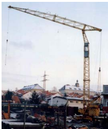
Der «Peschke TK 9» wurde im Jahre 1957 von der Firma Carl Peschke (Pekazett) entwickelt. Unterwagen und Drehbühne sind nicht mehr mittels «Königszapfen», sondern durch den moderneren Kugeldrehkranz verbunden.
