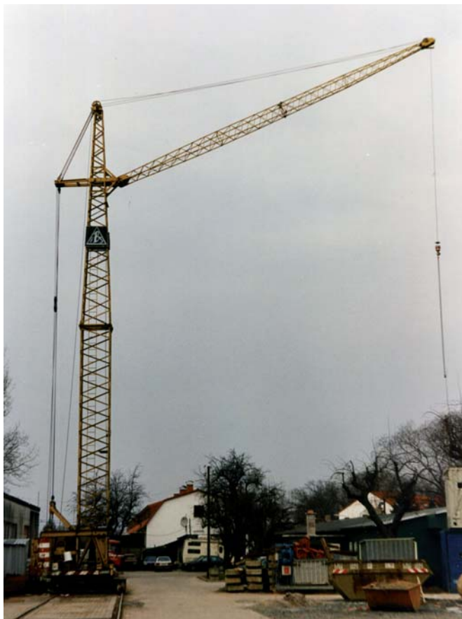
Der Turmkran «Liebherr F 20» mit unten liegendem Drehkranz wurde 1954 erstmals gebaut und wies ein Konstruktionsgewicht von rund 10,6 Tonnen auf, die normale Ausladung betrug 18 Meter, bei einer Tragfähigkeit zwischen 1,1 und 2 Tonnen.
