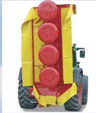
**Schwenkung nach hinten und hoch:** Das Mähwerk ist nahe am Schlepper und bewirkt dadurch eine geringere Vorderachs-Entlastung.
