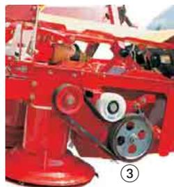
Ein federbelasteter Riemenspanner mit breiter Rolle sorgt auch bei Lastspitzen für einwandfreie Kraftübertragung. Einfach zu entspannen, der Keilriemen ist rasch abnehmbar. Zuverlässig geschützt vor Berührung mit Futter.
