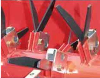
**V-förmige Stahlzinken** aus gehärtetem Stahl garantieren einen kontinuierlichen Futterfluss und hohe Standzeit. Elastisch sind die Zinken in Gummielementen gedämpft. Die Anordnung auf dem Aufbereiterrotor ist spiralförmig.
