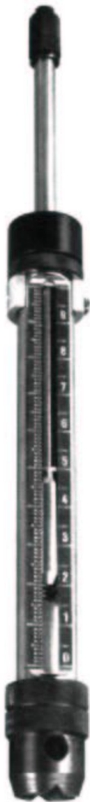
ZWICK típusú Sklerograf A leolvasott visszapattanási értéket Shore D, Rockwell C, Rockwell B, és Brinell keménységre lehet átszámítani.
