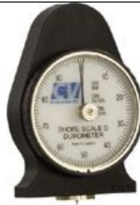
SHD0002 Shore keménységmérő, analóg, Shore D skálával, gumik, műanyagok stb. keménységének meghatározására
