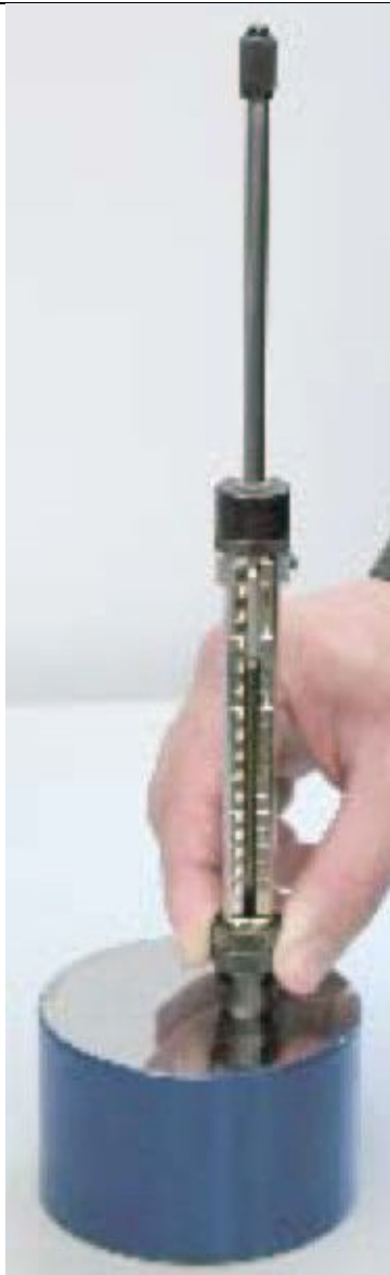
ZWICK típusú Sklerograf A leolvasott visszapattanási értéket Shore D, Rockwell C, Rockwell B, és Brinell keménységre lehet átszámítani.
