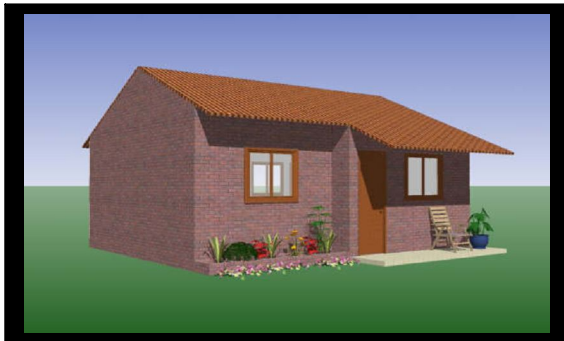
Figura 17 - Casa 3: telhado de cerâmica, alvenaria de tijolo aparente e esquadria de madeira.
