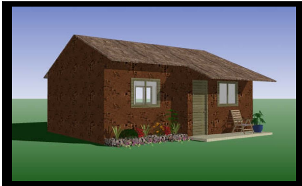
FIGURA 15 - Casa 1: telhado de sapê, alvenaria de taipa e esquadria de bambu.
