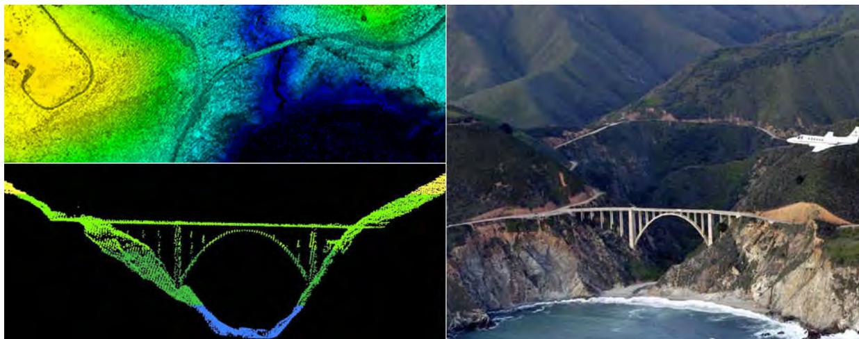
Los datos de LIDAR frecuentemente se recolectan vía aérea, como en este avión de la NOAA (arriba derecha) volando sobre Bixby Bridge en Big Sur, Calif. Los datos de LIDR revelan el puente (arriba la derecha) y un perfil de corte del Bixby Bridge (abajo a la izquierda). [Fuente NOAA](#)
