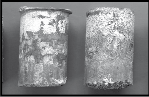
RYS. 1. Cylindryczne odlewy magnezowe przed procesem usuwania porogenu. FIG. 1. Cylindrical magnesium casts before porogen removal.
