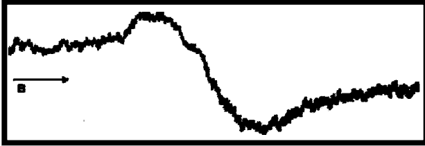
RYS. 1. Widmo EPR tramadolu rejestrowane przy tłumieniu 15 dB w dniu sterylizacji termicznej w temperaturze 180°C. B – indukcja pola magnetycznego.
