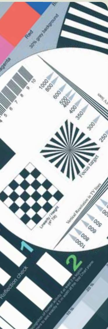
Mit dem Testchart lässt sich die Qualität eines Bildes nach Parametern wie Farbtreue und Kontrastschärfe beurteilen.
