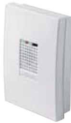
Der akustische Glasbruchmelder wertet die beim Glasbruch entstehenden akustischen Frequenzen aus. Dies ist überall dort von Vorteil, wo große Fensterflächen überwacht werden sollen. Um Falschalarmen vorzubeugen, achtet das Gerät beim Einschlagen der Scheibe neben dem Klirrgeräusch auch auf die Druckwellenfrequenz.
