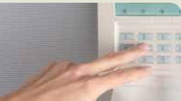
Eine Möglichkeit ist die Aktivierung der Anlage über das LCD-Bedienteil. Diese Bedienteile können an mehreren Eingängen montiert werden, so dass der Zutritt zum Haus nach wie vor über mehrere Wege möglich bleibt. Auch bei Objekten mit Stockwerken bietet sich der Einsatz des Zusatz-Bedienteils aus.
