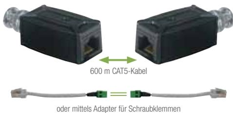
Aufstecken und fertig. So einfach realisieren Sie eine Übertragung von Videosignalen über bestehende 2-Draht-Leitungen. Dieses Sende-/Empfangsset setzt das Videosignal so um, dass vorhandene Zweidrahtleitungen zur Signalübertragung mit bis zu 600 m Kabellänge genutzt werden können. Zur Verbindung der beiden Module kann eine CAT5-Verbindung (mit RJ45-Buchsen) oder eine Schraubklemmenverbindung (Adapter im Lieferumfang) genutzt werden.
