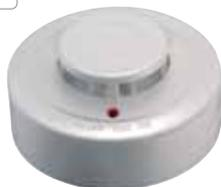
Um Falschalarme in Raucherzimmern, Küchen, Garagen, etc. zu vermeiden, wird dieser Melder eingesetzt. Er detektiert einen Alarm bei einer Temperaturveränderung höher als 3 °C innerhalb einer Minute oder bei über 60 °C Gesamttemperatur.
