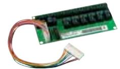
Durch Einsatz des Moduls stehen Ihnen 8 Relaisausgänge zur Verfügung. Die zusätzlichen Transistorausgänge werden belegt.
