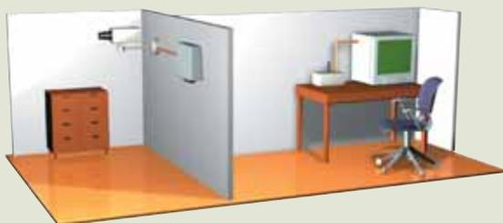
Anwendungsbeispiel: Standard-Kamera plus Universal-Funksender mit Indoor-Multi-Funkempfänger
