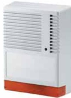
Dieser Alarmgeber verfügt über die Anschlussmöglichkeit einer integrierbaren Notstromversorgung, wodurch selbst bei einem durchtrennten Kabel ein lautstarker Alarm ausgelöst wird. Das Gehäuse mit massivem Stahlkern ist besonders robust und sabotagesicher.
