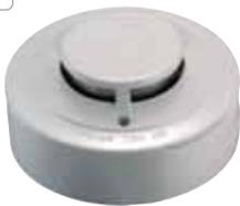
Optischer Rauchmelder zur Detektion sichtbarer Rauchpartikel. Die integrierte Infrarot-Lichtquelle erzeugt alle acht Sekunden einen Lichtimpuls. Sichtbare Rauchpartikel verändern das von einer Fotodiode empfangene Signal und der Melder löst einen Alarm aus.
