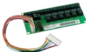
Durch Einsatz des Moduls stehen Ihnen 8 Relaisausgänge zur Verfügung. Die zusätzlichen Transistorausgänge der Zentrale werden dabei belegt. Wechslerkontakte NC/NO (max. 3 A/30 VDC).
