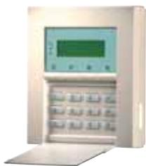
An jedem Eingang montiert, ermöglicht es Ihnen ein schnelles Bedienen Ihrer Alarmzentrale mit Pin-Code oder Proximity-Chipschlüssel (max. 4 Bedienteile). Abmessungen (HxBxT): 90x113x23 mm.
