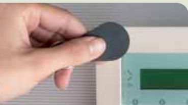
Am schnellsten und komfortabelsten lässt sich die Terxon mit dem Proximity-Chipschlüssel scharf- bzw. unscharf schalten. Halten Sie den Schlüssel einfach berührungslos vor die Zentrale oder das Bedienteil!
