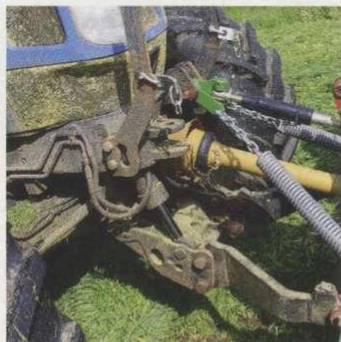
Über eine Oberlenker-Gabel können die Federn des Frontmähwerks ebenfalls eingehakt werden.
