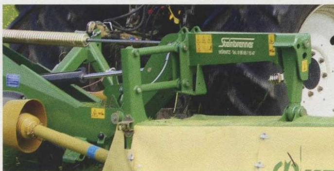
Die Aufhängung und Führung des Heckmähwerks erfolgt nach dem Prinzip DuoGrip im Schwerpunkt. Mit einem Parallelogramm werden die seitlich wirkenden Kräfte abgefangen. In Arbeitsstellung soll das Lenkerparallelogramm waagrecht zum Boden stehen.
