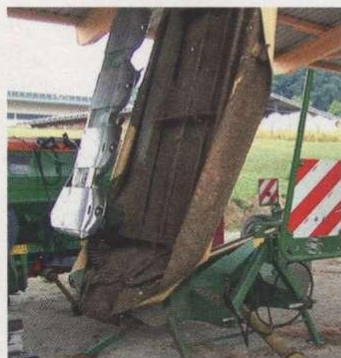
Praktisch: Das Heckmähwerk lässt sich in Transportposition auf engstem Raum in der Maschinenhalle abstellen.
