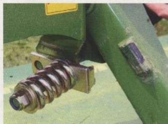
Die Anfahrsicherung am Heckmähwerk im ausgelösten Zustand. Eine federgespannte Klinke gibt das Mähwerk bei Gegendruck nach hinten frei. Das Einrasten zurück in Arbeitsposition funktioniert gut.
