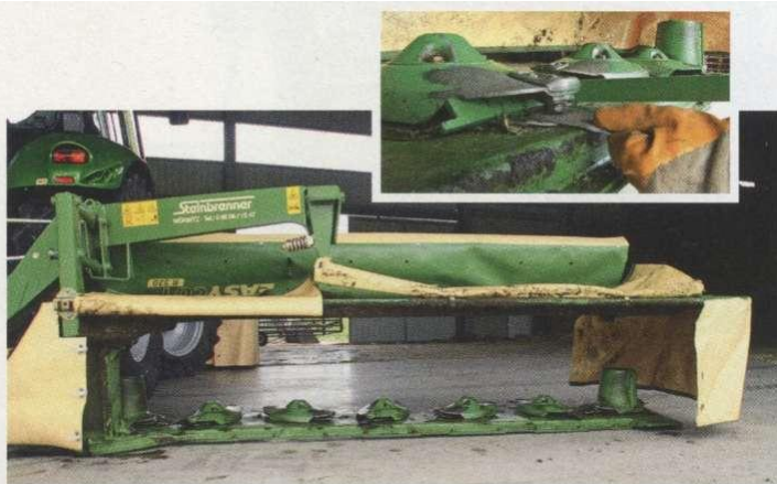
Der freitragende Schutzrahmen lässt jede Menge Platz auch bei starkem Futterbestand. Die Kraftübertragung auf das Satellitengetriebe findet nur auf der inneren Seite statt. Der Klingenwechsel erfolgt mit dem mitgeführten Werkzeug durch einfaches Unterfassen und Aufhebeln der Mäh-scheibe.
