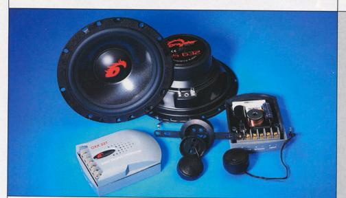
High Tech. Membrána středobasu je z lisovaného polypropylénu obohaceného uhlíkem, čímž je dosaženo větší tuhosti. Frekvenční vyhybka se strmostí 12 dB/oct, umožňuje pomocí přepínače 3dB zisk výškového reproduktoru. Pro výškáč byla použita kvalitní textilní membrána. Při instalaci můžeme využít dodávané příslušenství, které umožňuje jak povrchovou, tak
