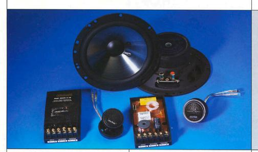
Ve firemní hierarchii zaujímá řada Mac Iron místo pod Mac Absolute a referenční Mac Maximus. Nosná část reproduktoru, koš z plechového výlisku, je přes gumový okraj spojena s membránou. Samotná membrána je vyrobena z osvědčeného polypropylénu pokrytého titanovým povrchem. Kmitací cívka 19mm výškového reproduktoru používá pro odvod tepla
