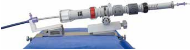
图 16 Edwards 全新 EVOQUE TMVR 输送系统设计特点
