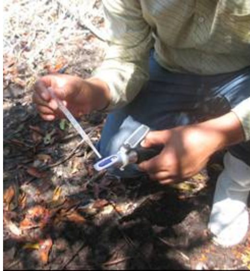
Figura VIII.13. Toma de muestra de salinidad intersticial
