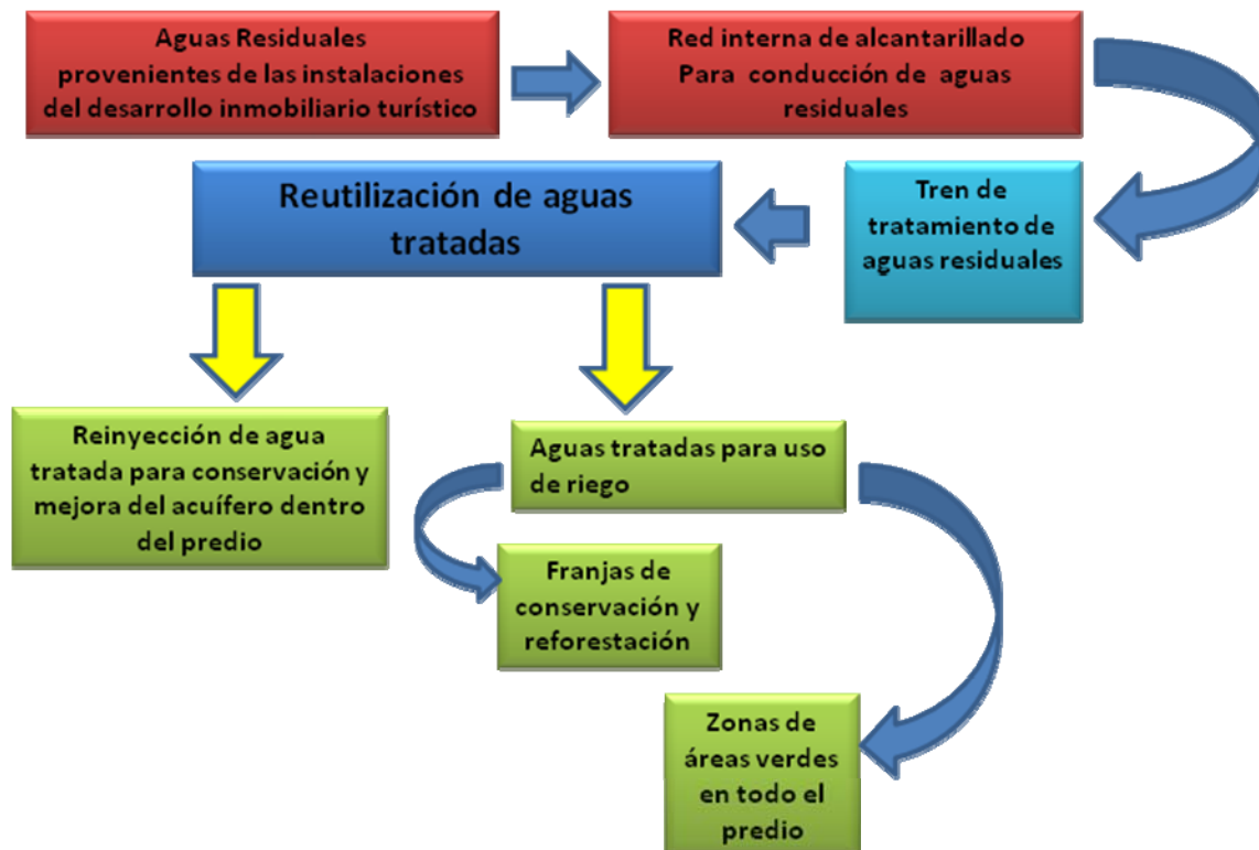
Figura VI.29 Diagrama de Manejo de Aguas Residuales.
