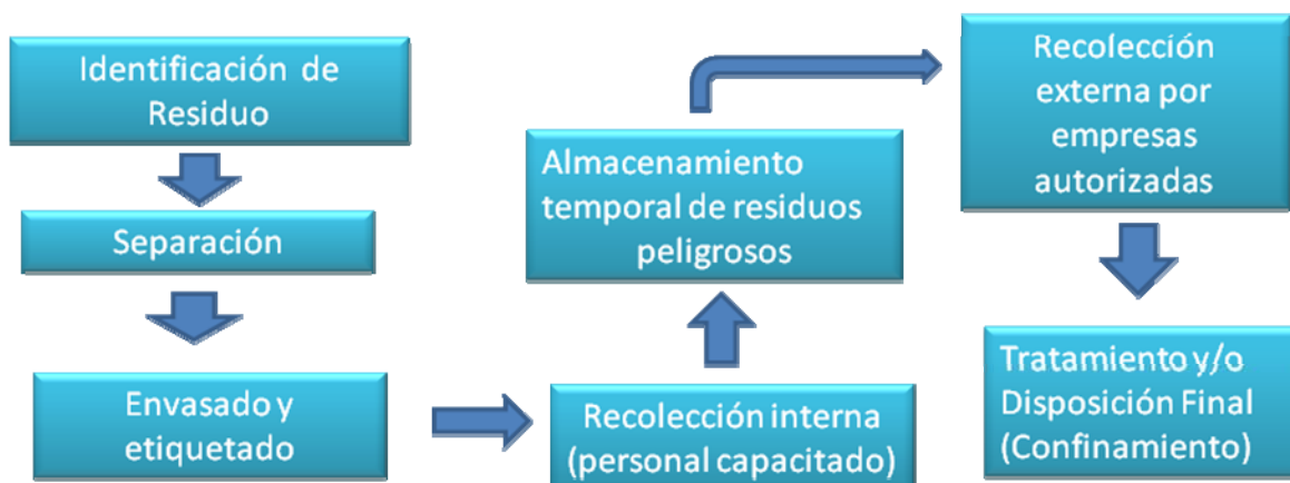
Figura VI.34 Diagrama de Manejo de Residuos Peligrosos.
