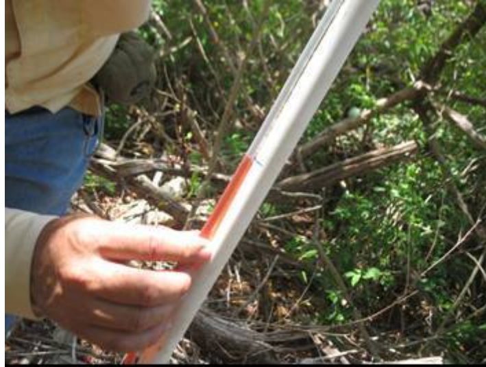
Figura VIII.10. Medición de un estadal mediante un nivel con un tubo de agua para transecto microtopográfico.
