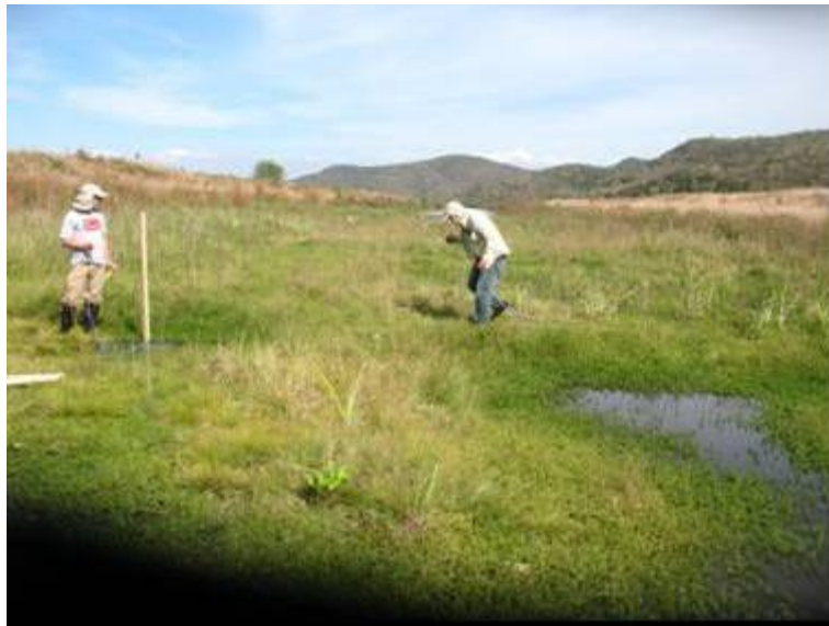
Figura VIII.11. Marcación de niveles en dos estadales.
