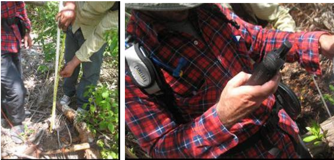
Figura VIII.13. Determinando la distancia de la marca del nivel al suelo y marcando el punto con un GPS.
