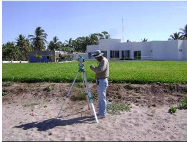
Figura VIII.2. Equipo empleado para el trazo de la Poligonal de Apoyo
