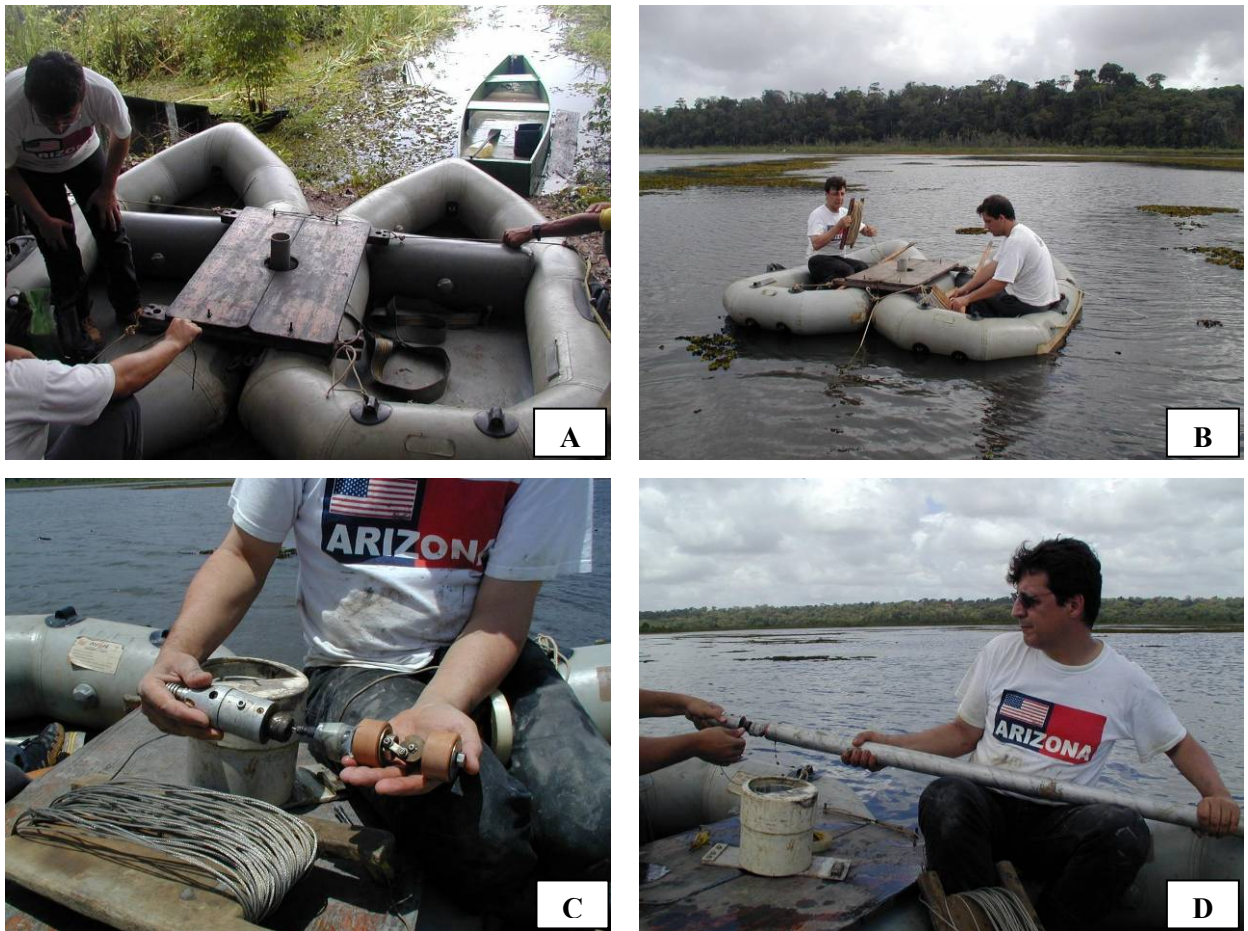
Figura 19 – Coleta do sedimento lacustre por meio de amostrador Livingstone; (A) montagem da plataforma flutuante; (B) Posicionamento e estabilização da plataforma para coleta; (C) Pistão do coletor Livingstone; (D) Tubo coletor com sedimento após coleta
