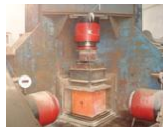
图2 油压测力千斤顶
