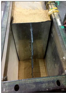
图 7 预应力返包式加筋土挡墙模型
