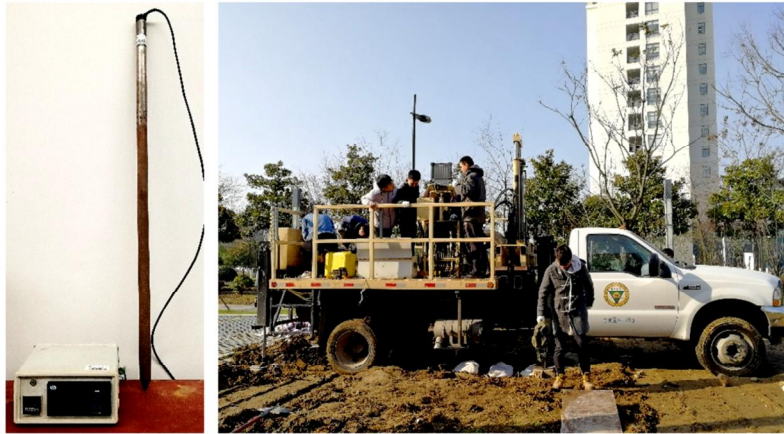
图8 热传导 CPT 测试系统与现场测试
