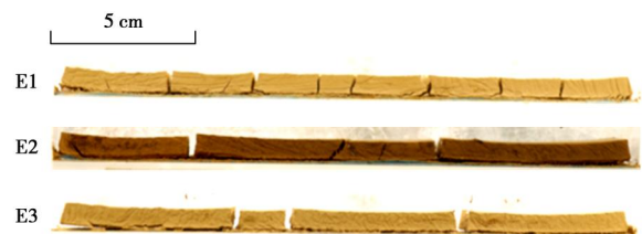
图3 室内试验最终裂隙图像(侧面)
