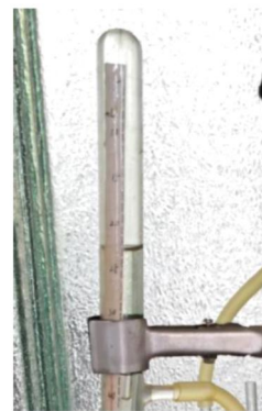
图 5 厌氧环境有机质分解模拟装置图(左)及生物气收集试管实物(右)
