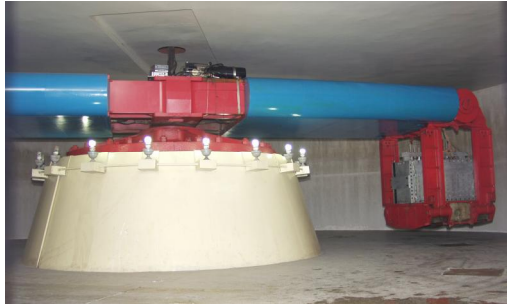
图2 NHRI 400 g-t 大型土工离心机
