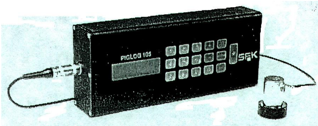
Figura 8: Medidor de espesor de grasa, espesor de músculo y estimador de porcentaje de magro.
