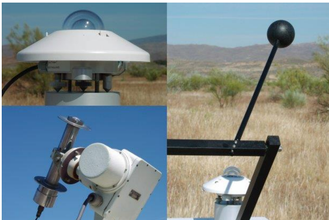
Figura 3. In alto a sinistra: piranometro per la misura della radiazione globale. In basso a sinistra: pireliometro per la misura della radiazione diretta. A destra: piranometro con sfera ombreggiante per la misura della radiazione diffusa. Immagine riprodotta da: www.volker-quaschnig.de .
