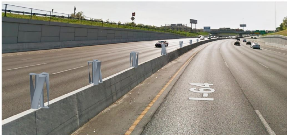
Figura 4.4. Model de turbine antrenate de curenții generați de circulația mașinilor (Sursa: ELSEVIER)
