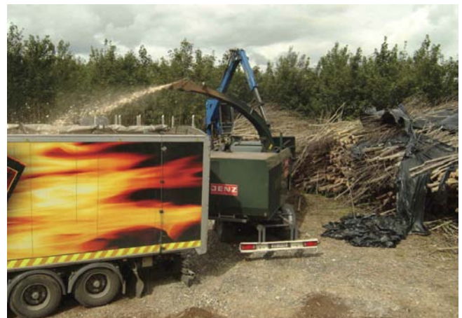
Figióir 3: Crainn fuinseoige iomlána, stóráilte faoi chlúdach plaisteach ag taobh an bhóthair thar an tsamhraidh 2006, slisithe le sliseoir téadaithe Jenz 700 isteach i leoraí urláir siúil.
