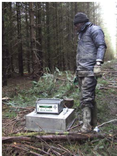
Figiúr 2: CO 2 agus toisí gáis rianta á thomhas agus anailiseoir fóta-fuaimiúla ar línte glas-seile á úsáid tar éis an dara tanaithe ag Doory (clampa 20 bliain d'aois).
