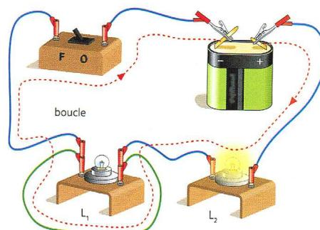
Quand on court-circuite un dipôle ce dernier ne fonctionne plus car tout le courant passe par le fil de court-circuit.
