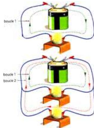
L'éclat de la lampe témoin ne dépend pas de l'ordre des dipôles ; les dipôles fonctionnent de façon indépendante.
