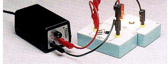
Si une lampe est grillée (ou dévissée), l'autre fonctionne encore car sa boucle est fermée.
