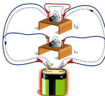
Quand on court-circuite un dipôle ce dernier ne fonctionne plus car tout le courant passe par le fil de court-circuit.
