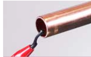
3. Gebruik een potloodtype ontbramer voor de binnenranden
