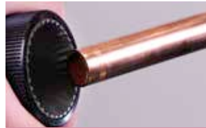
2. Ontbraam en verwijder alle scherpe randen aan de buitenkant
