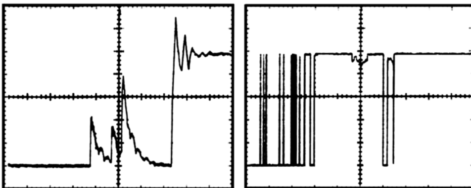
Abb. 4.13 Zwei typische Prellvorgänge (nach [4.46]).
