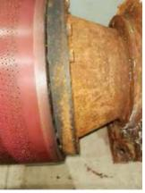
真空辊螺栓断裂处 图1
