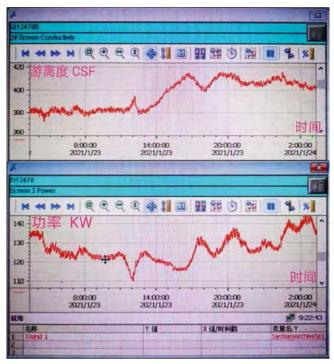
图2 压力筛功率和游离度值的比较
