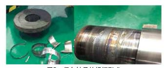
图5 径向轴承的损坏形式
