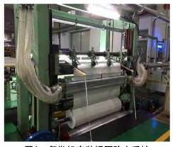
图4 复卷机安装纸页除尘系统
