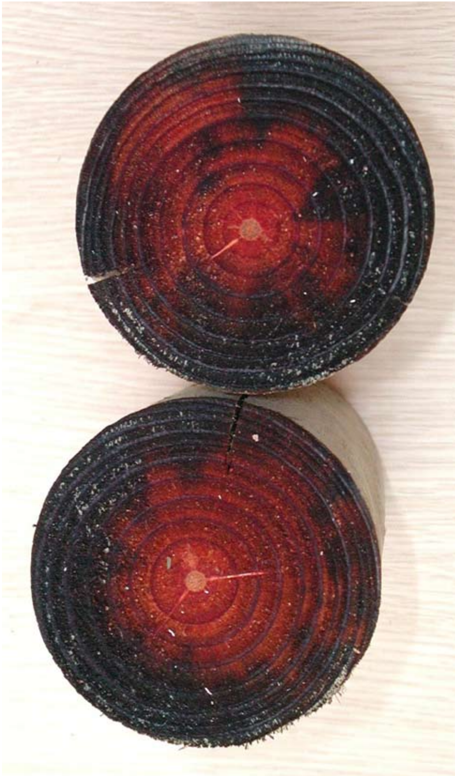
Sección transversal de rollizos de madera que han recibido un tratamiento protector
