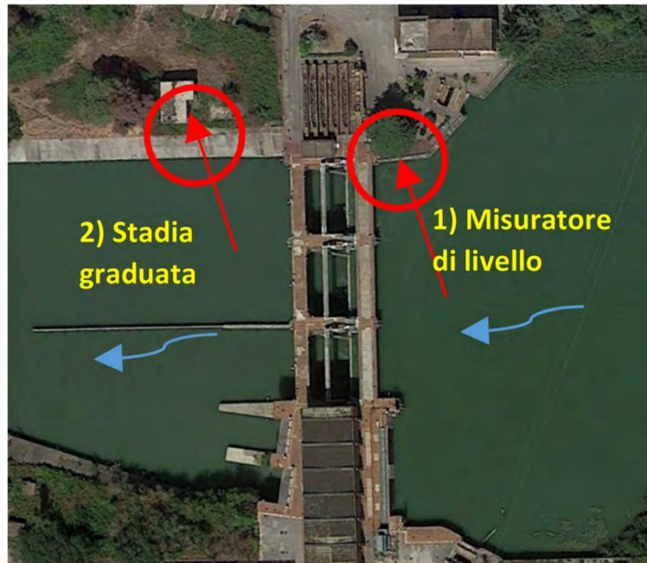
*Pinata con ubicazione dei punti di misura delle quote idriche, a monte (misuratore di livello) ed a valle della diga (Stadia graduata)*
