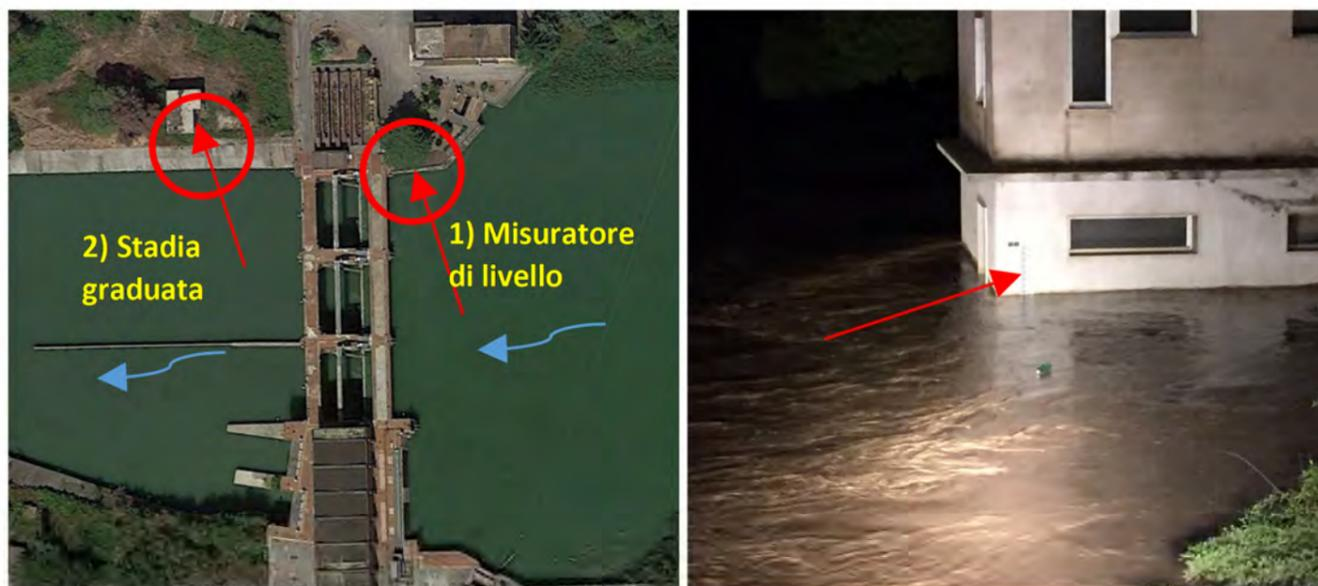
**Pinata con ubicazione dei punti di misura delle quote idriche, a monte (misuratore di livello) ed a valle della diga (Stadia graduata)**
