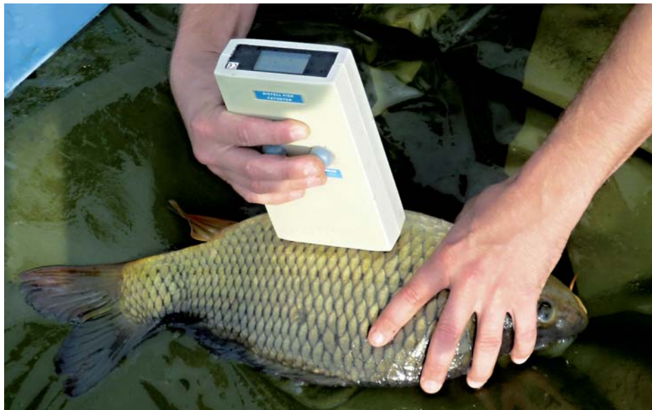
Měření obsahu tuku v těle živé ryby neinvazivní metodou
