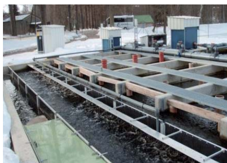
Biologické filtry recirkulačního systému dánského typu (Pravíkov)
