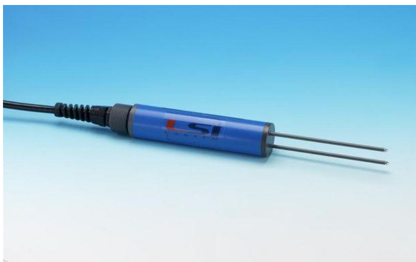
Priloga A2: Time domain reflectometry (TDR) senzor, za merjenje količine vode v tleh (ISI Belgium, 2015).
