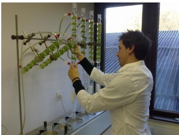
Slika 14: Priprava Soxhletovega aparata.
