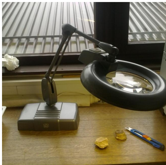
Slika 2: Lupa, ki smo jo uporabili za makroskopsko ločevanje vzorcev.
