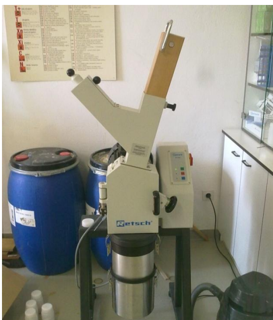
Slika 5: Mlin za mletje Retsch SM 2000.
