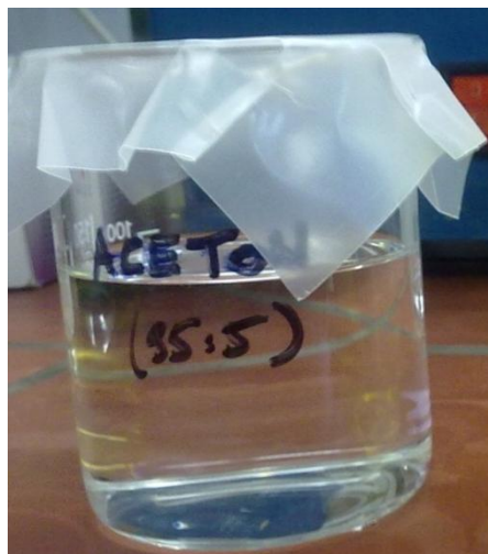
Slika 20: Aceton, redčen z destilirano H 2 O v razmerju 95:5.
