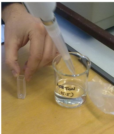
Slika 29: Aceton, razredčen z destilirano H_2O , ki je služil kot referenčni vzorec.
