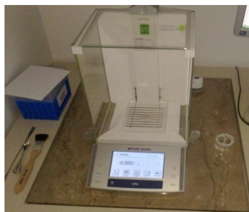
Slika 11: Laboratorijska tehtnica Mettler Toledo XS, na kateri smo izvajali vsa tehtanja.
