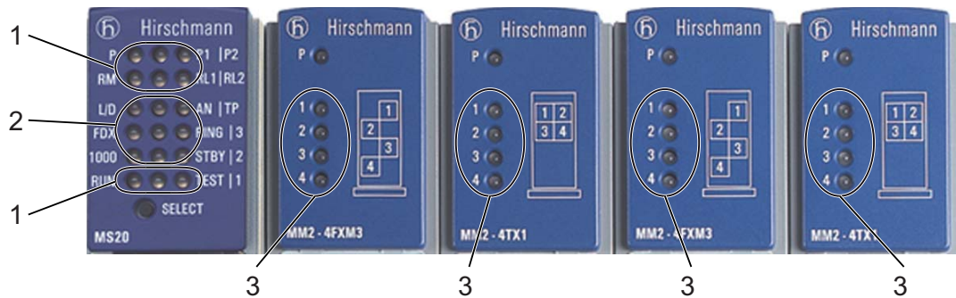
Abb. 11: Anzeigeelemente beim MS20/MS30 1 - Gerätestatus 2 - Anzeigestatus 3 - Portstatus
