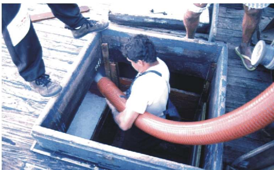
PRANCHIA X. A pesca do camarão em Piçarras (sistema IV). Em cima e no centro, “salgas” ou processadoras de camarão. Na primeira foto, máquina de descascar camarão; na segunda, “salga” dotada de câmaras fria e frigorífica. A foto inferior mostra o porão de um barco sendo carregado de gelo em escama com mangueira de ar comprimido. (Fotos: J. M. Andriguetto Filho)
