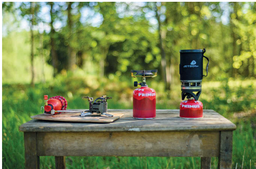
Kolme tüüpi matkapiidid (vasakult paremale): vedelkütusel ekspeditsioonipliit, kompaktne gaasiballoonile keeratav põleti ja integreeritud pliidisüsteem. Viimase juurde kuulub 0,8-liitrine pott. Pildil on näha ka kahes suuruses gaasiballoonid (450 g ja 230 g)
