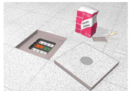
Bodenbelag in Kassettendeckel einkleben
