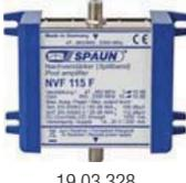
Breitbandiger Ein- und Ausgang (47-2300 MHz), interne Weiterführung der Fernspeisespannung zum LNB sowie des 22 kHz Tones und der Di-SeqC-Signales
