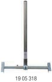
Montage auf / zwischen den Dachsparren, Erdungsanschluss, komplett aus verzinktem Stahl, nach unten offener Mast ermöglicht Kabeldurchlass
