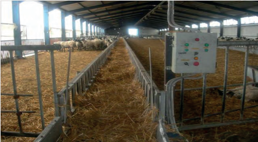
Εικόνα 17. Σύγχρονο ζωοστάσιο. Παρατηρούμε πως η αριστερή πλευρά του κτηρίου είναι ανοιχτή έτσι ώστε να επιτρέπεται ο σωστός φωτισμός και αερισμός.
