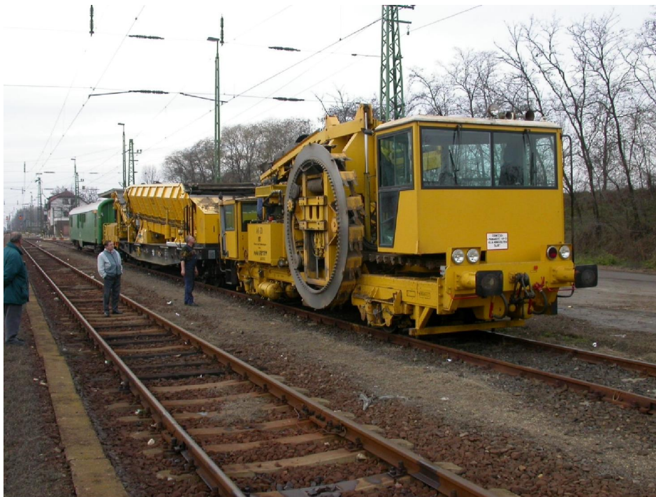
Fig. 16 Balastforiga maŝino por ĉesigi la lokajn trakdeformiĝojn
