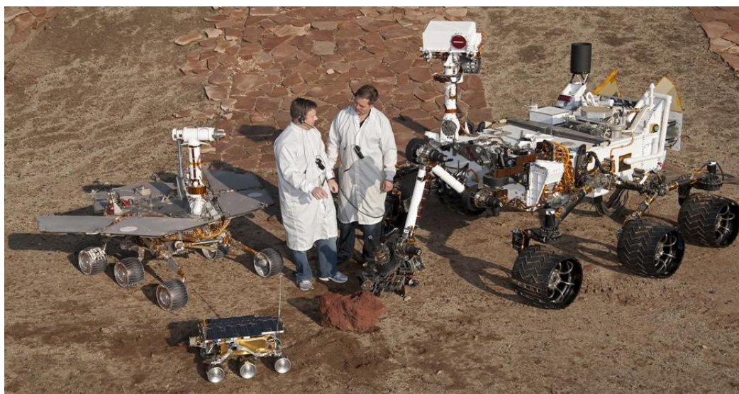
Figuro 4: Tri generacioj de marsaj veturiloj : Sojourner (la plej malgranda), Spirit/Opportunity (maldekstre) kaj Curiosity (dekstre)
