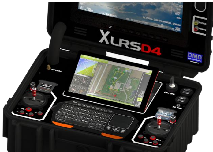
Bildo 9: Ekzemplo de flugrobota kontrolilo, kun integrita videmontrilo kun informoj pri la roboto kaj la kameraa vido
