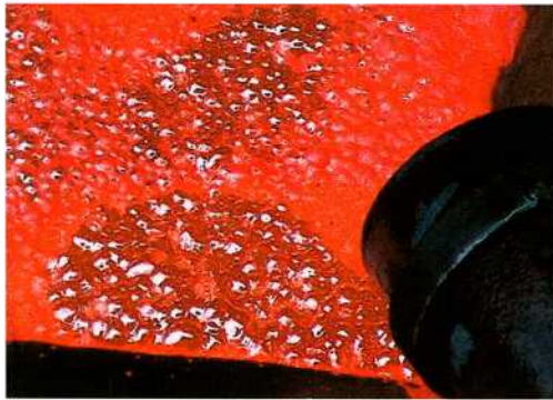
Abb. 4: Oberfläche eines Ochsenhautbarrens, 8 Minuten nach dem Abguss. Es hat sich eine gasundurchlässige Erstarrungshaut gebildet. Das darunter aufgestaute Gas wölbt die Erstarrungshaut an vielen Stellen auf.
