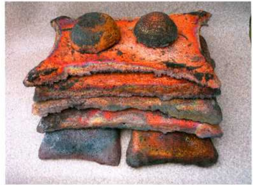
Abb. 10: Sechs experimentell hergestellte Ochsenhautbarren und zwei bun ingots. Gewicht der einzelnen Ochsenhautbarren: 28-30 kg. Barrenlänge über alles: 65 cm. Die bun ingots konnten ohne zerkleinert werden zu müssen in bronzezeitlichen Flachtiegeln (s. Abb. 11) umgeschmolzen werden.
