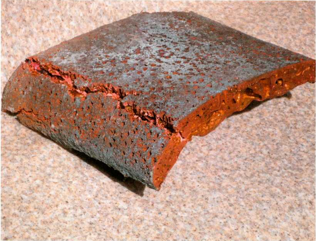
Abb. 9: Unterseite eines experimentell hergestellten Ochsenhautbarrens mit pinholes. Im Querschnitt des Barrens sind die an der Barrenoberseite (im Bild unten) liegenden Makroporen zu erkennen. Der extrem poröse Ochsenhautbarren konnte mühelos zerbrochen werden.
