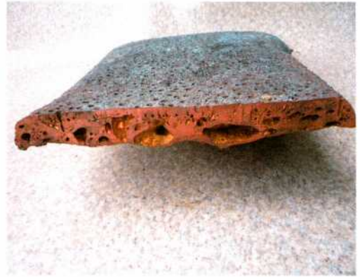
Abb. 5: Experimentell gegossener Ochsenhautbarren im Querschnitt mit schlauchförmigen Poren auf der Barrenunterseite (im Bild oben). Auf der Barrenoberseite (im Bild unten) sind Makroporen zu sehen, über denen sich die Gusshaut aufgewölbt hat.
