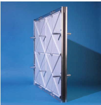
Sistema di facciata sospesa sviluppata nell'ambito della tesi di dottorato di Jan Cremers, TUM, Germania.
