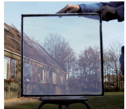
Prototipo di una finestra contenente aerogel monolitico sviluppata nel progetto europeo HILIT. Fonte: K.I. Jensen, J. M. Schulz
