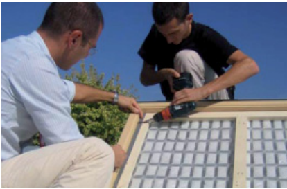
Box-test della Velux Italia per la sperimentazione di finestre con un blanket contenete PCM. Colognola ai Colli, Italia. Fonte: Velux Italia.
