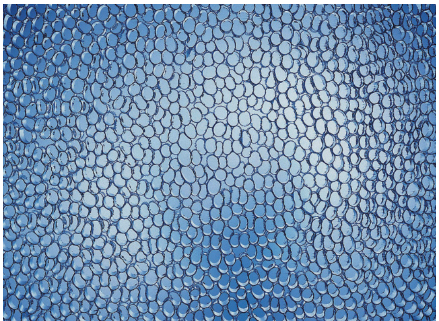
Immagine ingrandita di un pannello isolante trasparente a struttura capillare. Fonte: Okalux, Marktheidenfeld, Germania.
