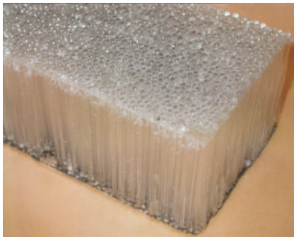
Porzione di un pannello in TIM a cannelle orientate per schermare la radiazione solare nelle ore più calde e favorire l'ingresso della luce quando il sole è più basso sull'orizzonte.
