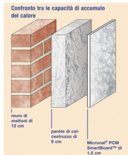
Confronto tra le capacità di accumulo di calore di materiali differenti. Fonte: BASF.
