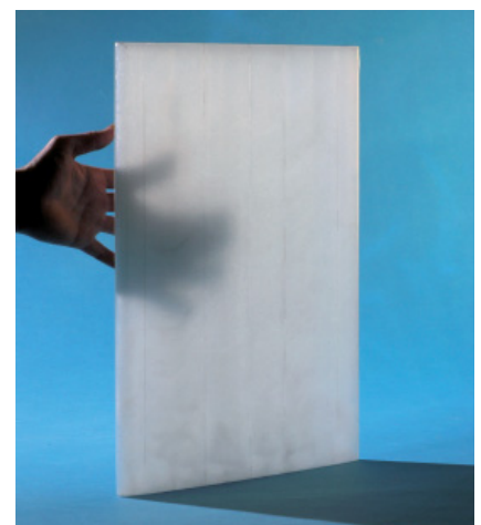
Prototipo di una lamella in policarbonato contenente aerogel granulare. Fonte: Jan Cremers
