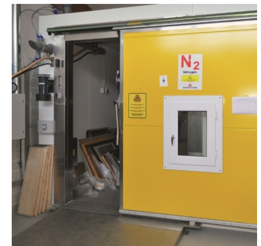
Câmara de nitrogênio para anóxia.
