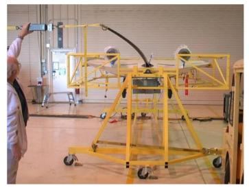
Drogue Boom Load Test<sub>EOT\_RT\_Sub\_Template.ppt | 15</sub>
