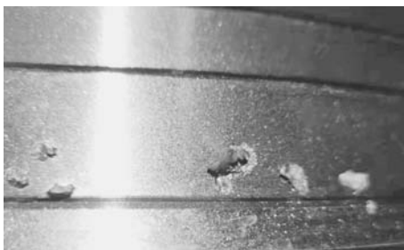
图3 飞轮的缩孔缺陷
