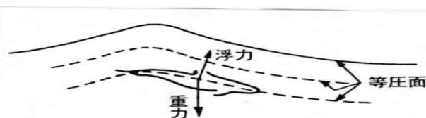
図25 イルカは水面ではなく、水面下の等圧面の傾きに乗ってサーフィンを楽しむ。
