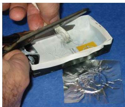
Εικόνα 43. Κατασκευή γύψινου καλουπιού βάσεως (προσθήκη ινών).
