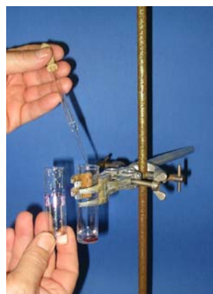
Εικόνα 40. Προσθήκη σταγόνων κορεσμένου διαλύματος ιωδιούχου καλίου.
