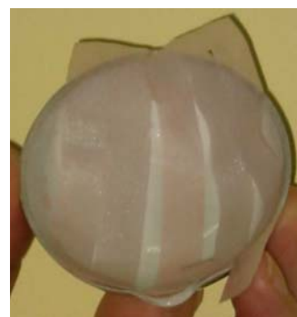
Εικόνα 10. Δείκτης διαποτισμένος με υδρατμούς.
