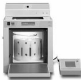
Εικόνα 14. Εργαστηριακός φούρνος μικροκυμάτων. (Milestone Ethos TouchControl, Milestone, Italy, www.milestonesci.com )
