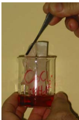
Εικόνα 26. Παρασκευή δείκτη χλωριούχου κοβαλτίου.
