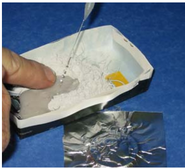
Εικόνα 44. Κατασκευή γύψινου καλουπιού (προσθήκη γύψου και νερού).
