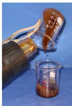
Εικόνα 33. Θέρμανση και συνένωση δύο ποσοτήτων πολυμερούς.
