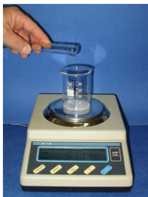
Εικόνα 27. Προετοιμασία και ζύγιση διαλύματος γαλακτικού οξέος και διαλύτη.
