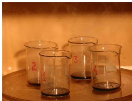
Εικόνα 28. Θέρμανση και πολυμερισμός δειγμάτων γαλακτικού οξέος.
