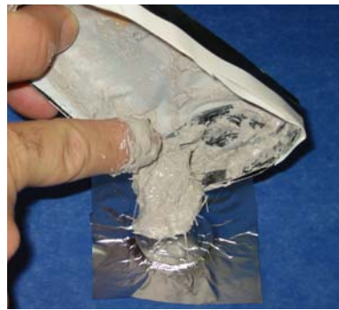
Εικόνα 45. Κατασκευή γύψινου καλουπιού (διαμόρφωση).
