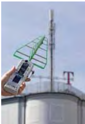
Medició de contaminació electromagnètica.
