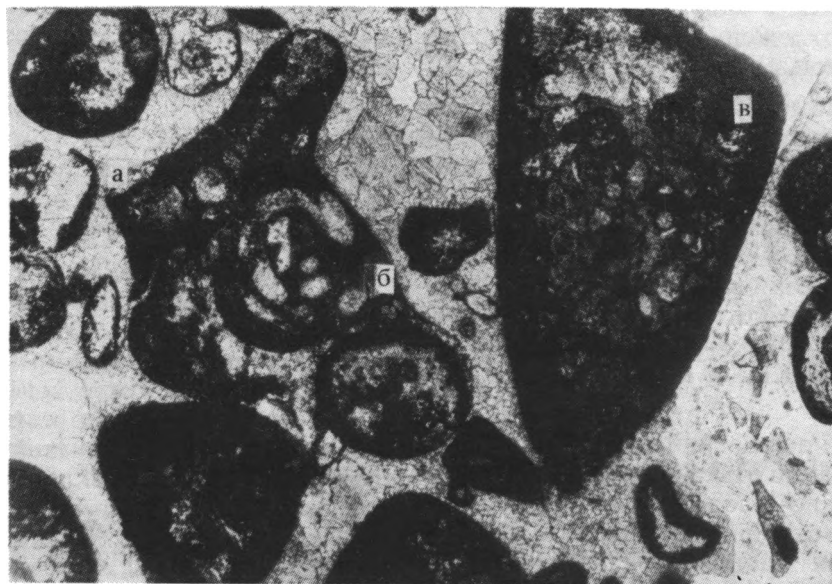
Рис. 6. Обломочный известняк (грейнстоун). В интракласте наблюдаются аллохтонные фораминиферы Forshiella prisca Mikh. (а), Globoendothya sp. (б), в матриксе – аллохтонная известковая водоросль Koninckoroga sp. (в). \times 25 . Скв. 2 Бурлинская, шл. 89487–1, интервал глубин 4284–4280 м. Нижний карбон, верхнее визе.
