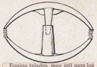
Equipo taladro, muy útil para los revisores de tren en el supuesto de que se olviden la herramienta usual.
