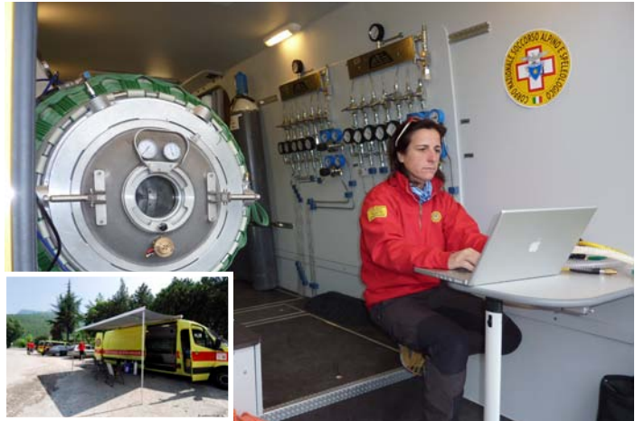
LA COM.SUB NAZIONALE DISPONE DI UNA CAMERA IPERBARICA MOBILE, DISLOCATA PRESSO LA STAZIONE OPERATIVA DELLA REGIONE LAZIO
