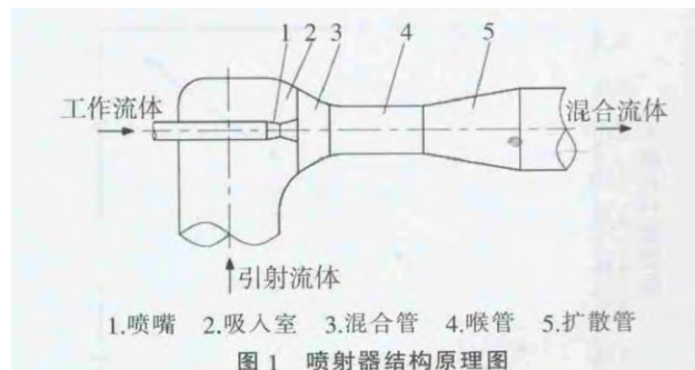
图1 喷射器结构原理图
