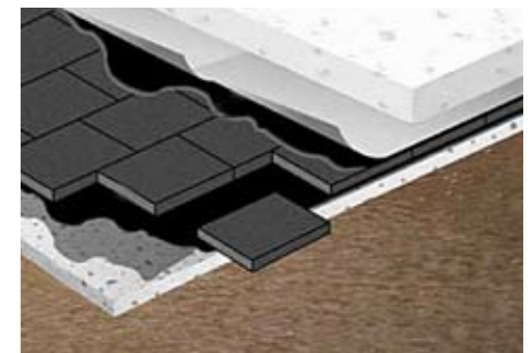
BU: Der Öko-Baustoff Foamglas ist ideal geeignet als Wärmedämmung im erdberührten Bereich, z.B. zur Bodendämmung. Bild: tdx/Deutsche Foamglas
