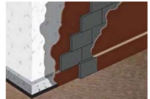
BU: Der Öko-Baustoff Foamglas ist ideal geeignet als Wärmedämmung im erdberührten Bereich, z.B. zur Außendämmung eines Kellers. Bild: tdx/Deutsche Foamglas
