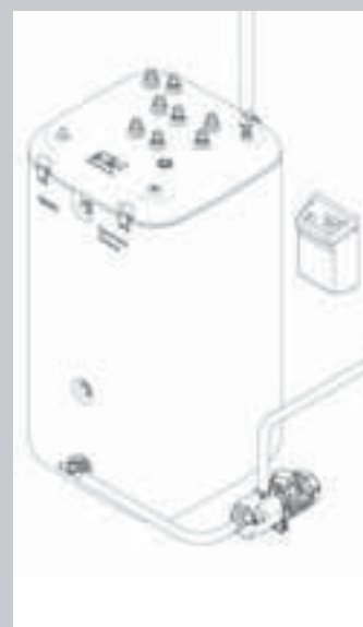
Drain-Back-System Großanlagen DB
