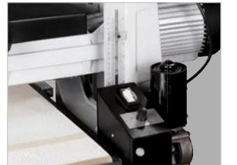
Höhenverstellung der Schleifeinheit an einer Skala ablesbar
