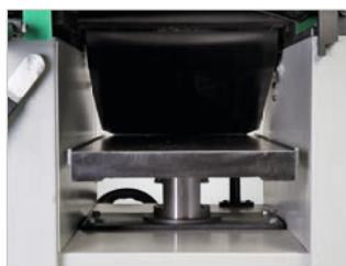
Dickentischverstellung über Handrad, Skala und numerischer Anzeige
