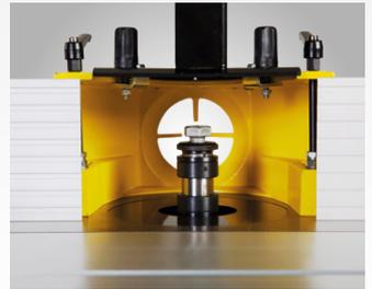
Frässpindel mit 80 mm Nutzlänge und 30 mm Durchmesser
