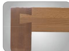
Schwalbenschwanzverzinkung in Hinterzange und Beiladerücken
