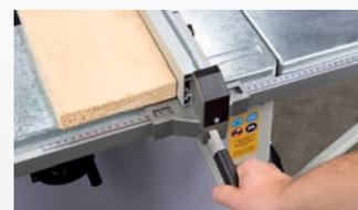
Der große Aluminium Parallelanschlag mit Exzenter-Schnellspannung kann per Skala präzise und leicht eingestellt werden.
