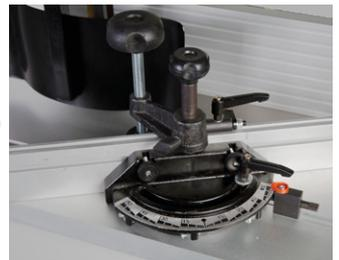
Stufenlos verstellbarer Winkelanschlag
