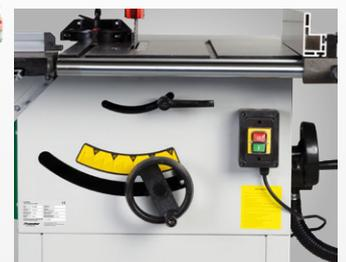
Mit genauer und leichtgängiger Höhen- und Schrägverstellung des Sägeaggregats durch einfach zu bedienendes Handrad
