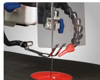
Komplett ausgestattet: Sägeblattschutz, Werkstückniederhalter und Gebläsedüse
