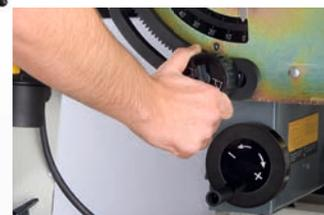
Sägeblattschwenkung von 0° bis 45°, präzise und gradgenau, erfolgt über Handrad und Skala
