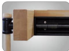
Massive Linearführung an der Hinterzange
