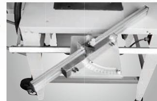
Kugelgelagerter Schiebeschlitten mit Gehrungsanschlag, stufenlos einstellbar von -45° bis +45° mit Schnellklemmhebel
