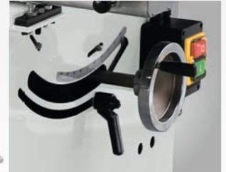
Sägeblattschwenkung von 0° bis 45°, bequem verstellbar über Drehknopf und Skala per Zahnstangenmechanismus
