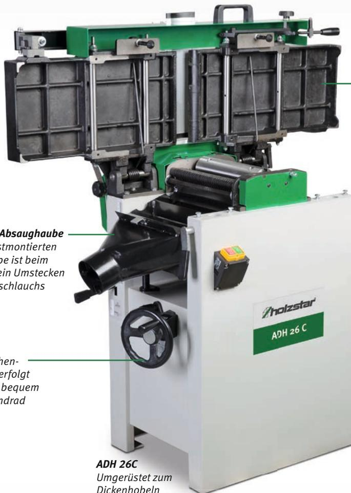
**Gleichzeitiges Öffnen der Abrichttische**
