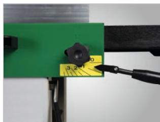
Verstellung der Spanabnahme über Bedienelement
