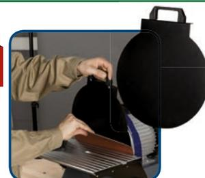
**Trennblech zum Schleifscheibenwechsel**
